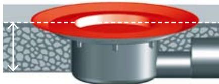
Nova funkcionalna građevinska zaštita kod HL-a svojim oblikom jamči odlično polaganje na betonsku podlogu (košuljicu). Brtveća garnitura se može postaviti bez ikakvih problema. Na taj je način isključeno da prirubnica prelazi preko ruba betonske podloge.
